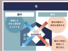
アヤホームでは何年も前から換気の重要性を認識しており、24時間強制的に換気を行う第一種換気システムを取り入れています。この換気システムは空気を入れ替える時に「熱交換」という空気エネルギーの再利用を行うため、外の空気を室内の空気に近い状態で取り込み、より快適な状態で換気が可能です。
